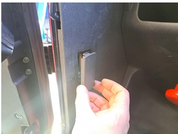
Ota oven alemman saranan kiinnitysmuttereiden suojakansi pois.
