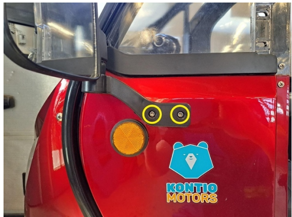
Irrota sivupeilin kiinnityspultit. (kuusiokoloavain 5 mm). Ota sivupeili pois.
