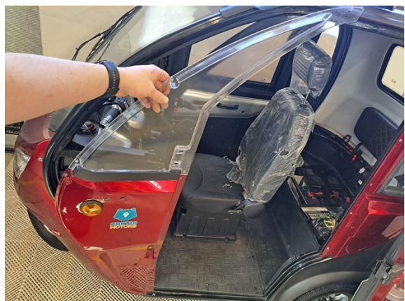
Ota etummainen sivuikkuna/ sivupaneeli pois.
