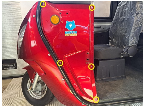
Irrota etusivupaneelin kiinnitysruuvit. (ristipäämeisseli ph2).
